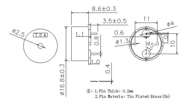
Unit:mm Tolerance :  $\pm$ 0.5mm
